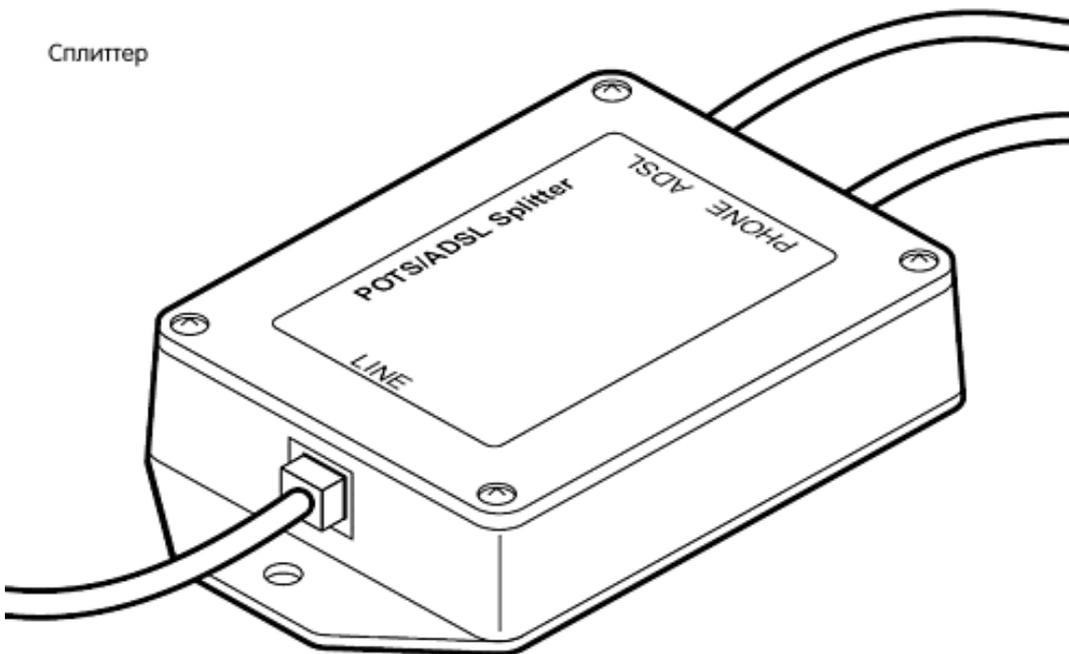
Приходящая телефонная линия подключается к гнезду Line сплиттера . Модем — к гнезду ADSL или Modem. Телефонные аппараты — к гнезду Phone.
